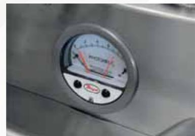
OPT. Differenzdruckmessgerät Photohelic
